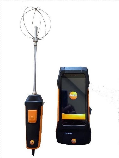
Testo 400 avec sonde à fil chaud
